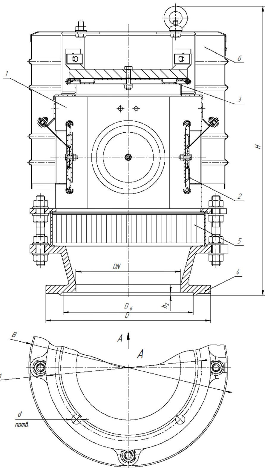
1 - корпус, 2 - тарелка вакуума, 3 - тарелка давления, 4 - фланец, 5 – огнепреградитель, 6 – кожух.
